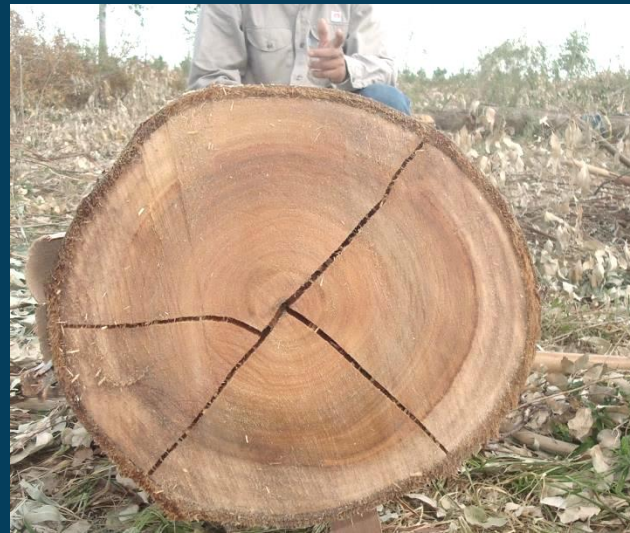
Variación rajaduras en caras de rollizos 72 horas posteriores al apeo. Ubajay 2011
