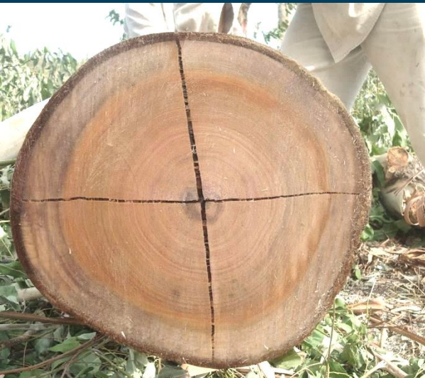
Variación rajaduras en caras de rollizos 72 horas posteriores al apeo. Ubajay 2011
