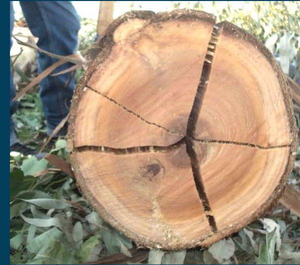
Variación rajaduras en caras de rollizos 72 horas posteriores al apeo. Ubajay 2011
